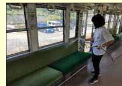
コーティング剤施工
